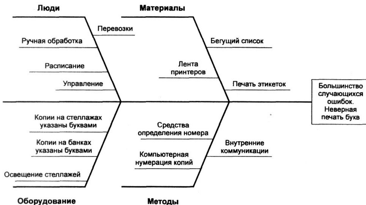
Рис. 6.2. Причинно-следственная диаграмма ошибок сортировки видеокассет
