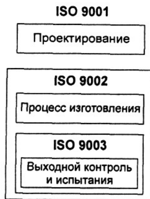
Рис 6.5. Взаимосвязь между тремя сериями стандартов ISO 9001,9002 и 9003 Разработка и внедрение системы качества
